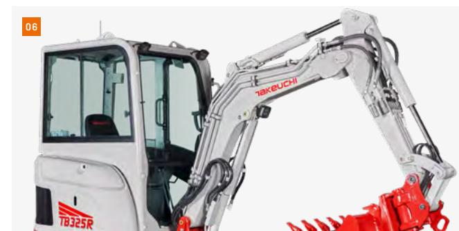
01 Cabina de confort insonorizada y con pocas vibraciones, con asiento de confort ergonómico y con amortiguación mecánica para trabajar sin fatiga.
