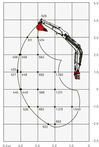
Las cargas indicadas en la tabla no superan el 87% de capacidad de elevación hidráulica o el 75% de carga de vuelco.
