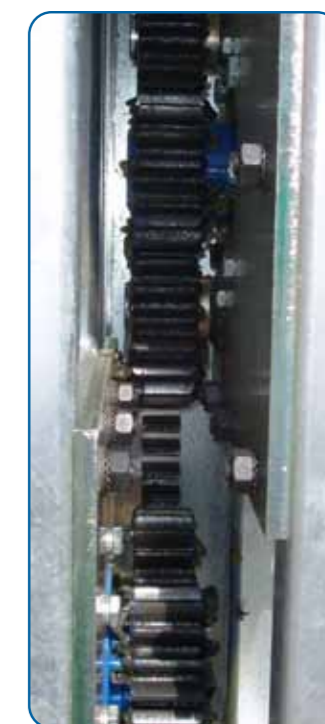
Piñones del grupo motriz y paracaídas Drive unit and overspeed brake pinions
